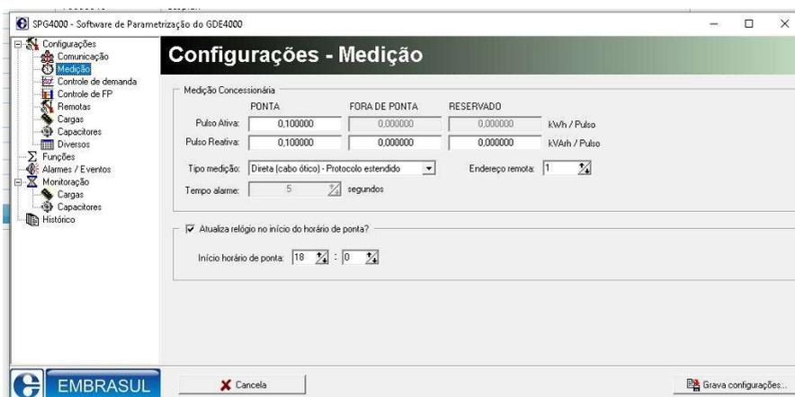
Nesta tela é necessária a configuração da relação de consumo por pulso recebido do medidor. Estas informações podem ser obtidas diretamente com a concessionária ou disponibilizadas na conta de energia elétrica do consumidor (Especificações técnicas do medidor).
